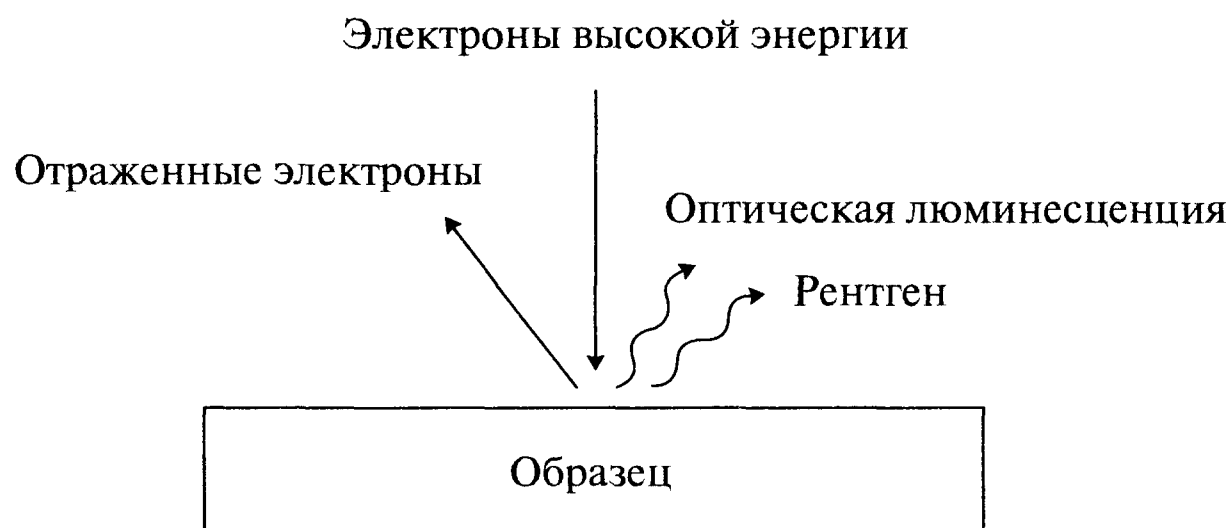
Рис.6.5. При столкновении электронов с материалом появляются отраженные электроны, рентгеновское излучение и катодолуминесценция.
