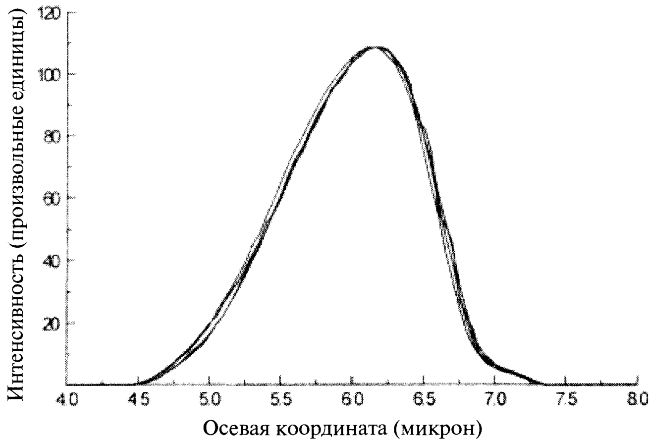
Рис. 4.31. Воспроизводимость перемещения образца по координате Z иллюстрируется измерением интенсивности сигнала при повторных движениях зеркала по оси Z .
