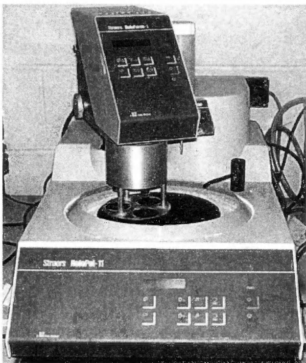
Рис. 3.4. Устройство Struers RotoPol-11 для полировки образцов. Эта машина позволяет одновременно полировать три образца.
