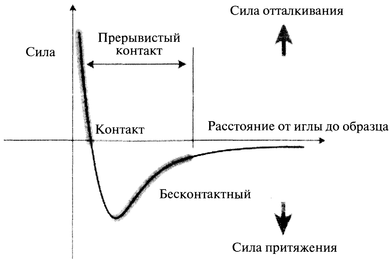
Рис. 5.9. Типичная зависимость силы взаимодействия от расстояния между кончиком консоли и поверхностью образца. Выделены участки кривой, относящиеся к различным режимам работы силового микроскопа.
