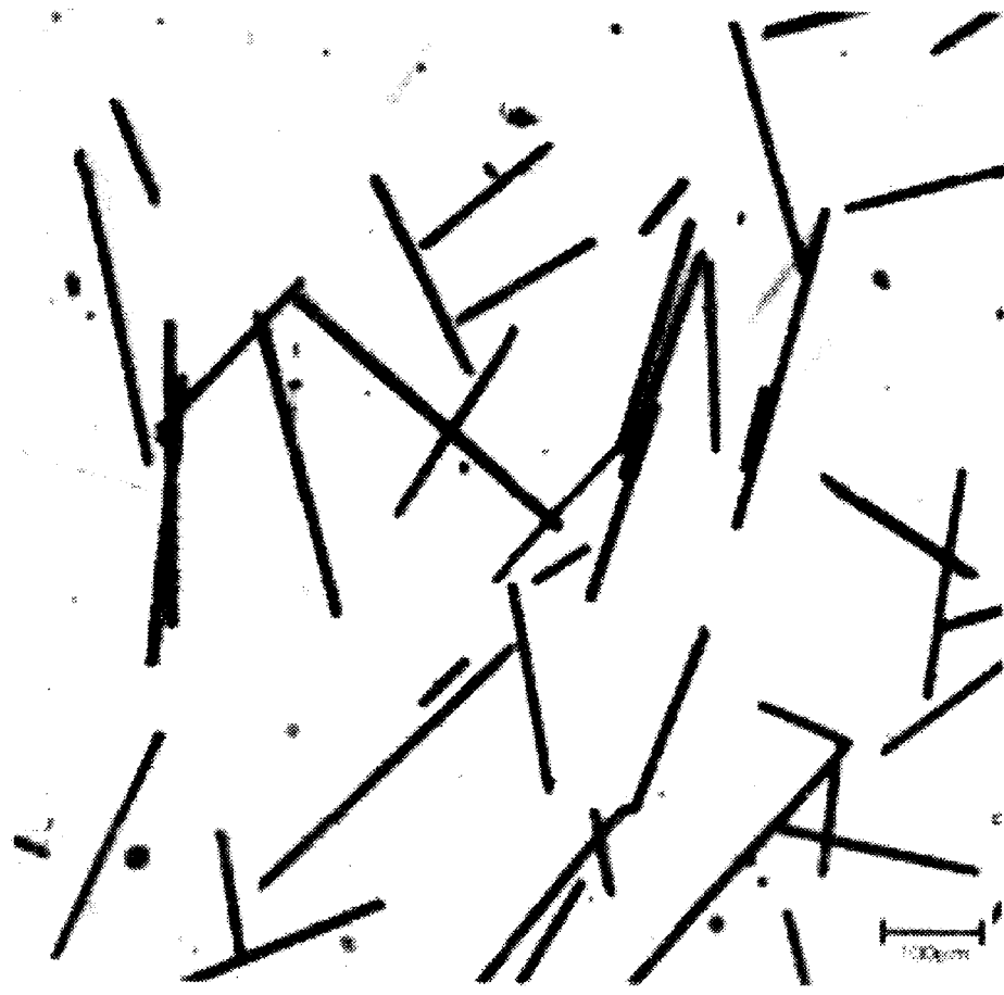
Рис. 3.47. Изображение волокон в оптическом микроскопе проходящего света после пиролиза матрицы. Обратите внимание на наличие пересекающихся волокон.
