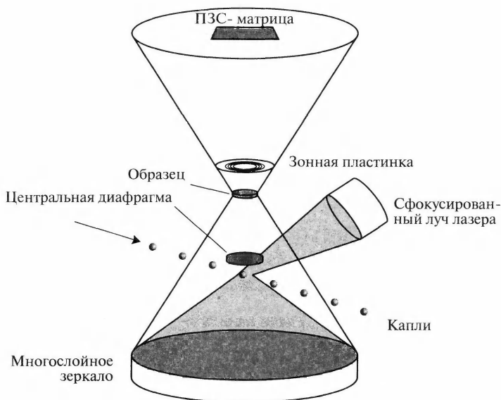
Рис. 5.25. Аппарат Берглунда состоит из плазменного источника мягкого рентгена, возбуждаемого лазерным облучением капельной мишени, многослойного конденсорного зеркала, образца и зонной пластинки, обеспечивающей получение изображения высокого разрешения на чувствительной к рентгену ПЗС-матрице, освещаемой с тыльной стороны.
